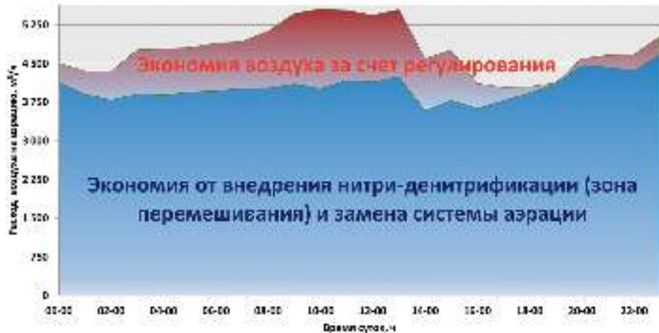
Рисунок 10. Составляющие эффективности регулирования подачи воздуха
