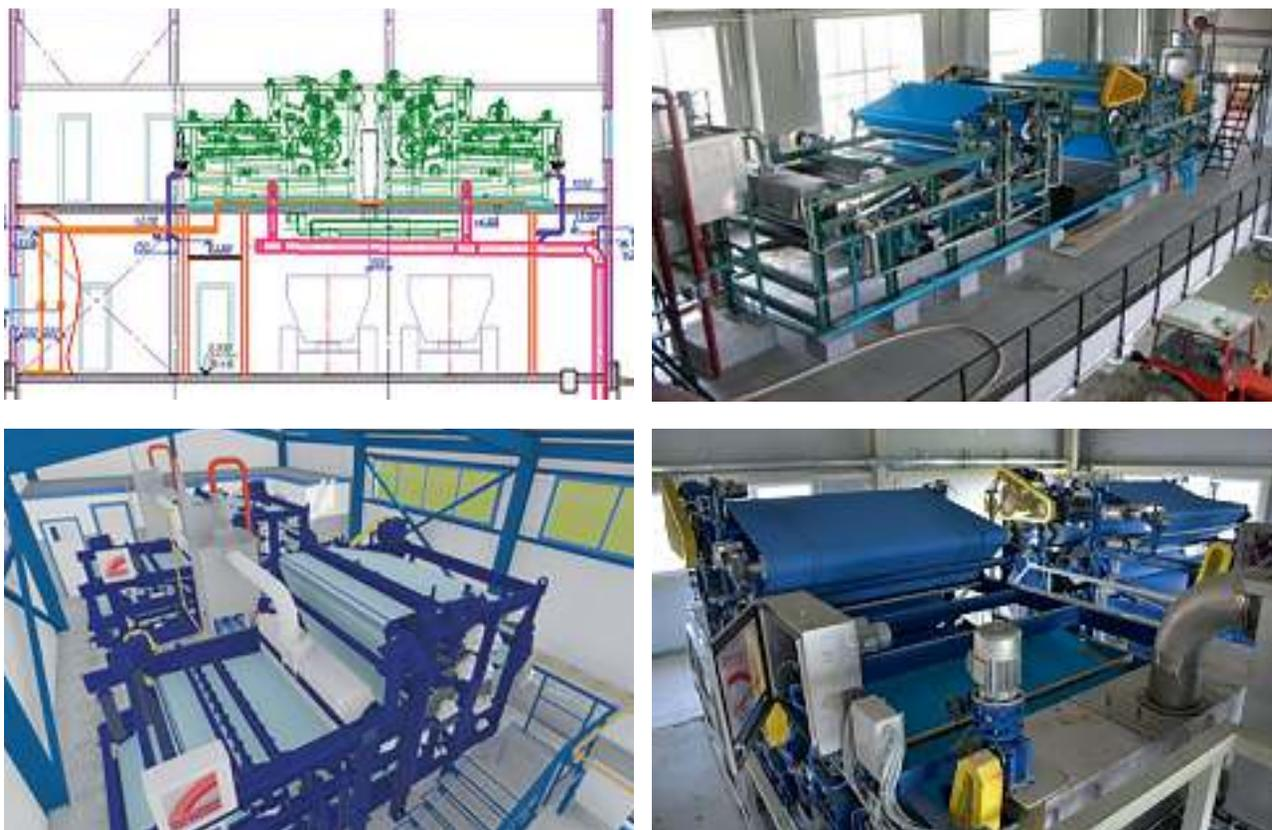
**Рисунок 2. Размещение оборудования внутри цеха**
