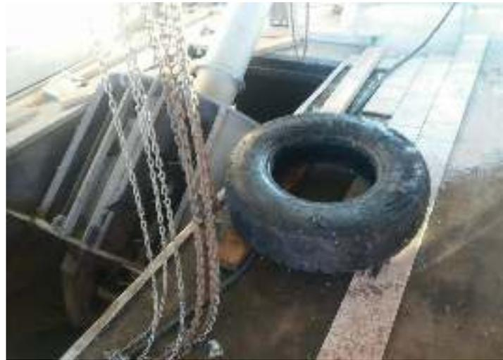
**Рис. 2. Покрышка, деформировавшая полотно барабанной решетки**
