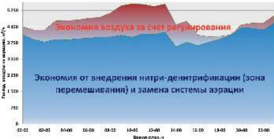
Рисунок 10. Составляющие эффективности регулирования подачи воздуха
