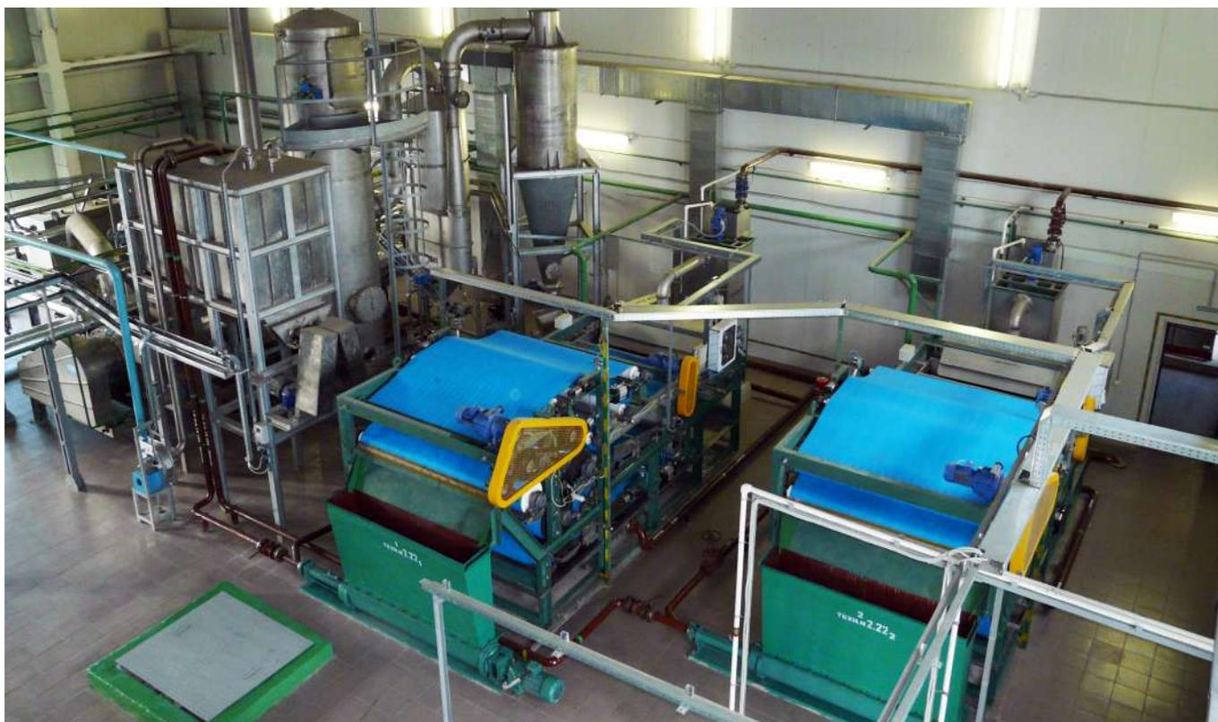
*Ленточные фильтр-прессы производства ТПП «Экополимер»*
