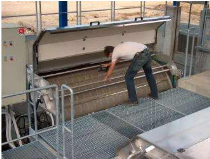
Сита с вращающимся барабаном с промывкой снаружи
