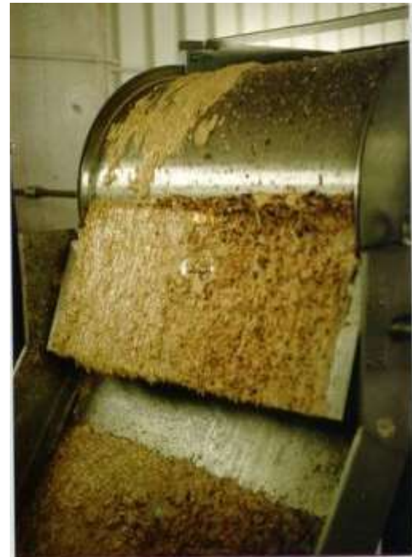
Сита с вращающимся барабаном с промывкой изнутри
